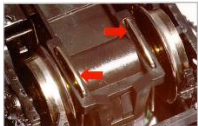
Afbeelding 11: Zit van de contactbeugel wisselsensor
